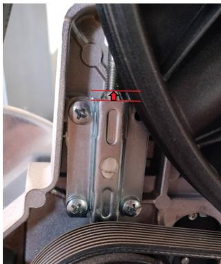
4) Svitare completamente la vite di tensionamento con una chiave a brugola da 5 mm e rimuovere la cinghia.
